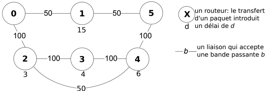
Étant donné  $n = 6$  routeurs, il faut déterminer le chemin optimal de paquets du routeur 0 (la source) au routeur  $n - 1 = 5$  (la destination). Le transfert de tout paquet par un routeur introduit un délai noté  $d$ . Les liaisons possèdent une bande passante (capacité) maximale noté  $b$ . En fonction de différentes contraintes (voir ci-dessous), il peut y avoir plusieurs solutions optimales :
