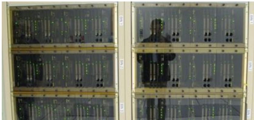
corrélateur : 170 TFlops, 8200 FPGA, 180 KW
