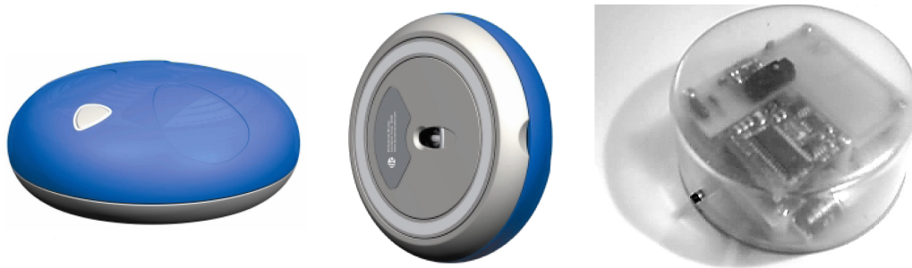
FIG. 2.23: La souris à trois DDL Cylo : vue latérale supérieure (gauche) et vue de la base (centre). A droite, le prototype qui a été construit. Figures et photo extraites de Crew (2002).
