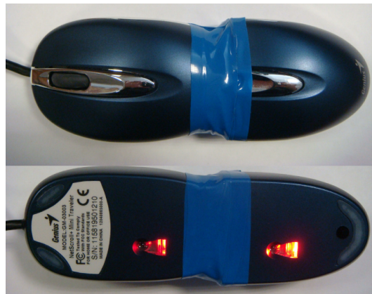
FIG. 2.20: Le TwistMouse : vue de la partie supérieure (en haut) et vue de la base (en bas). Photos extraites de Hannagan (2007).
