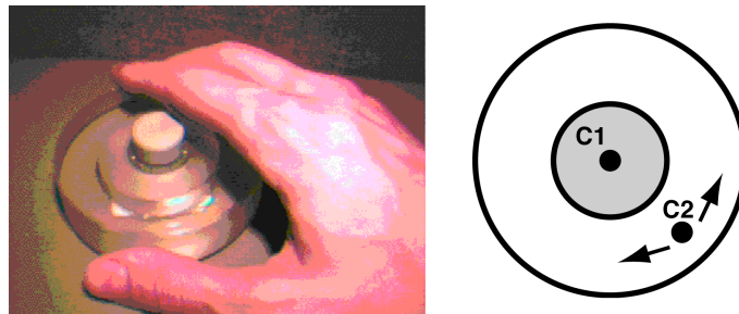
FIG. 2.17: A gauche, le dispositif Scrubwheel . A droite, schéma du dispositif : l'anneau périphérique, contenant le capteur C2, tourne autour de l'anneau central, qui contient le capteur C1. C1 fournit la position du dispositif sur la tablette magnétique tandis que C2 fournit une orientation (relative à C1). Photo extraite de Fitzmaurice (1996).
