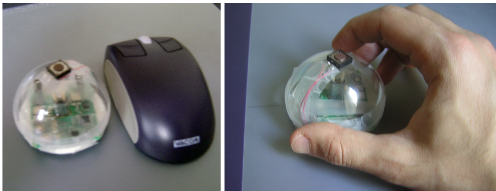
FIG. 5.4: Le prototype de la souris rotative fait à partir du 4D Mouse.
