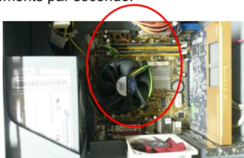
Circuits électroniques composés de millions de transistors placés dans un boîtier comportant des connecteurs d'entrée-sortie, surmonté d'un ventilateur.
