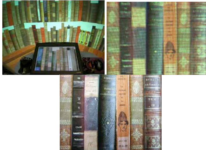
Figure 4. A gauche, la vue globale de la scène sur la VisionStation. Au milieu, le détail de livres au centre de la projection. A droite, la même partie de l'image affichée sur l'écran plat. Noter les différences dans la qualité des images affichées.
