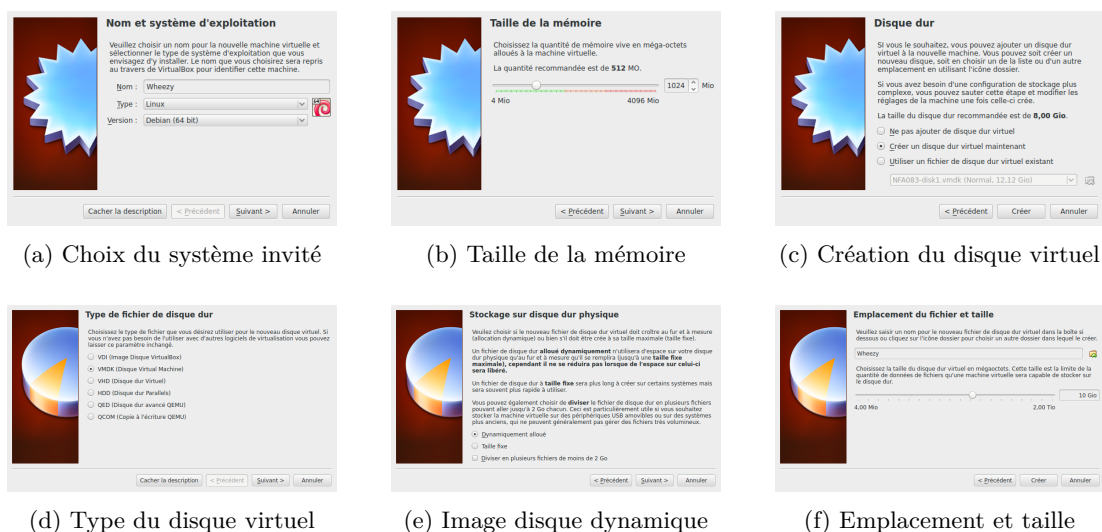
FIGURE 2 – Création d’une machine virtuelle avec VirtualBox
